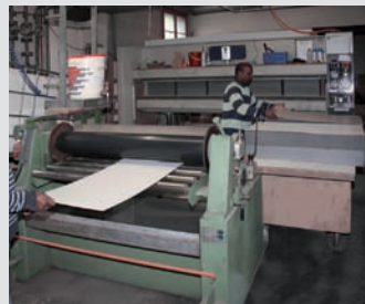
Deckschicht Renolack-Platte oder Hartfaserplatte wird vollflächig mit Wärmedämmung verleimt
