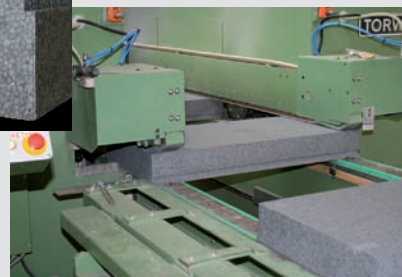
ATTICA-THERM Spezial-Längsprofil wird gefräst, anschliessend Querprofil
